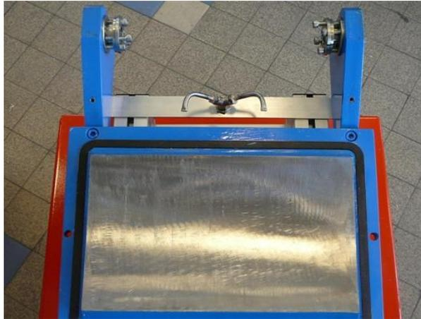
Positionner la trappe sur la table élévatrice
