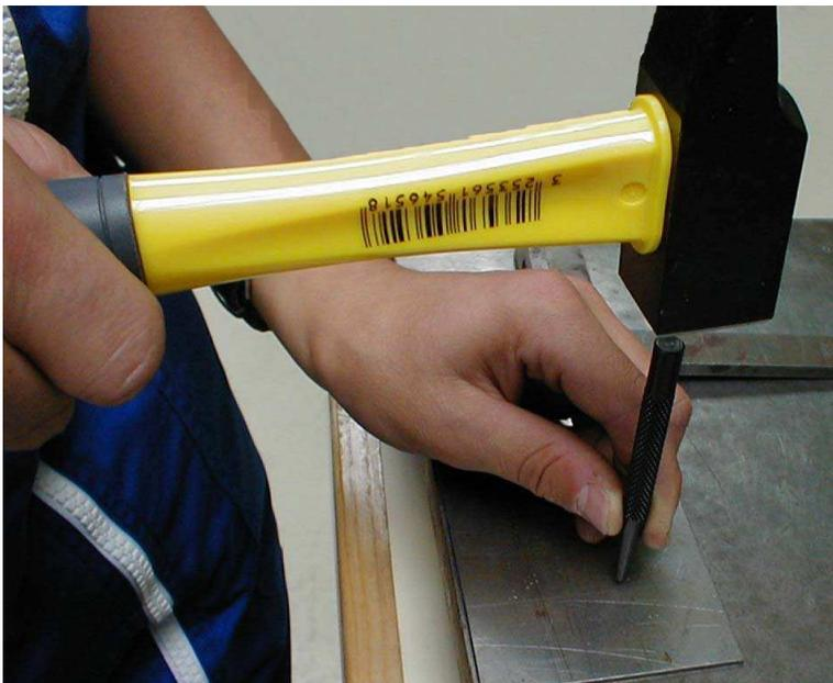
Il se réalise à l'aide d'un **marteau** et d'un **pointeau**. On pose le pointeau à la **verticale** sur l'endroit à pointer (cet endroit est déterminé par l'**intersection** de 2 traits de traçage) et on **frappe légèrement** avec le marteau.
