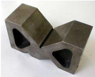
Il s'agit d'un **bloc** en fonte rectifiée. Les différentes faces possèdent de très faibles tolérances de **planéité** et de **perpendicularité**. Il sert d'**appui** à la pièce à tracer. Ses entailles en **forme de Vé** permettent de positionner, avec précision, des pièces **cylindriques** de différents diamètres.
