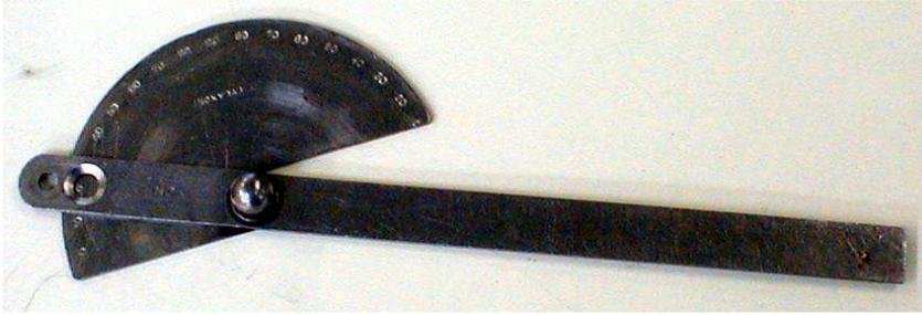
Il est constitué d'une règle pivotant sur un rapporteur. La **mesure lue** sur le rapporteur indique l'angle que forme la **règle avec la base du rapporteur**. Les cotés de la règle servent de **guide** pour le **traçage à plat**.
