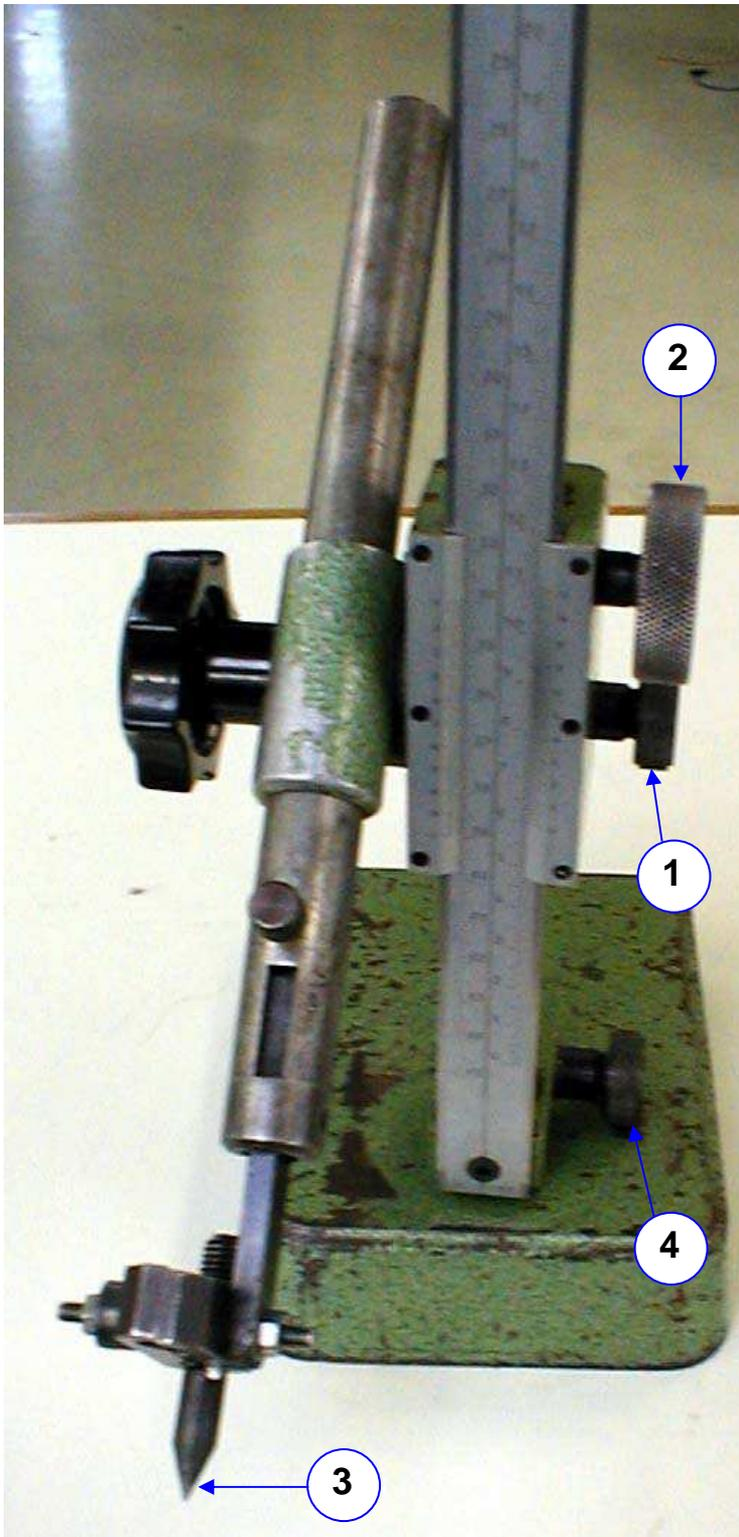
C'est un outil permettant le **traçage en l'air**. C'est à dire de tracer des lignes horizontales à différentes hauteurs.
