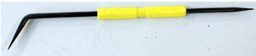
Munie de bouts pointus en acier de grande dureté, elle va servir à griffer la **pièce métallique** et laisser sur celle-ci une **trace**.
