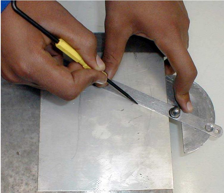
Il s'agit d'un traçage à plat. Ce traçage se réalise à l'aide d'un **marbre** et d'un **rappporteur d'angle**. La **pièce** est posée à **plat sur le marbre**. On **règle** le rapporteur d'angle à **l'angle désiré**, on appuie la **base du rapporteur** contre la **surface** de référence, puis on trace à l'aide de la **pointe à tracer** en prenant **appui** sur la règle du rapporteur d'angle.
