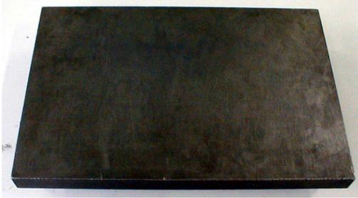
Il s'agit d'une **plaque** en fonte rectifiée. La face supérieure possède une très faible tolérance de **planéité**. Il sert de **support** à la pièce à tracer et à l'utilisation de l'outillage de traçage.
