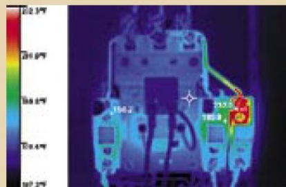
Les connexions de cette pompe d'évaporation présentent un excès de 50 degrés à la phase C.
